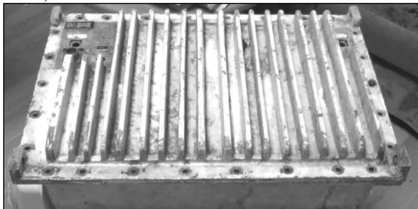
Emițătorul TV dezmembrat din sistemul de ghidare a rachetelor
